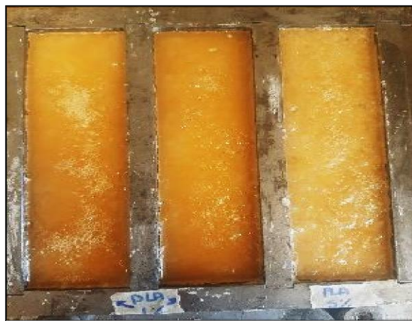
Figura 6. Elaboración de probetas con resina, mármol y PLA.
